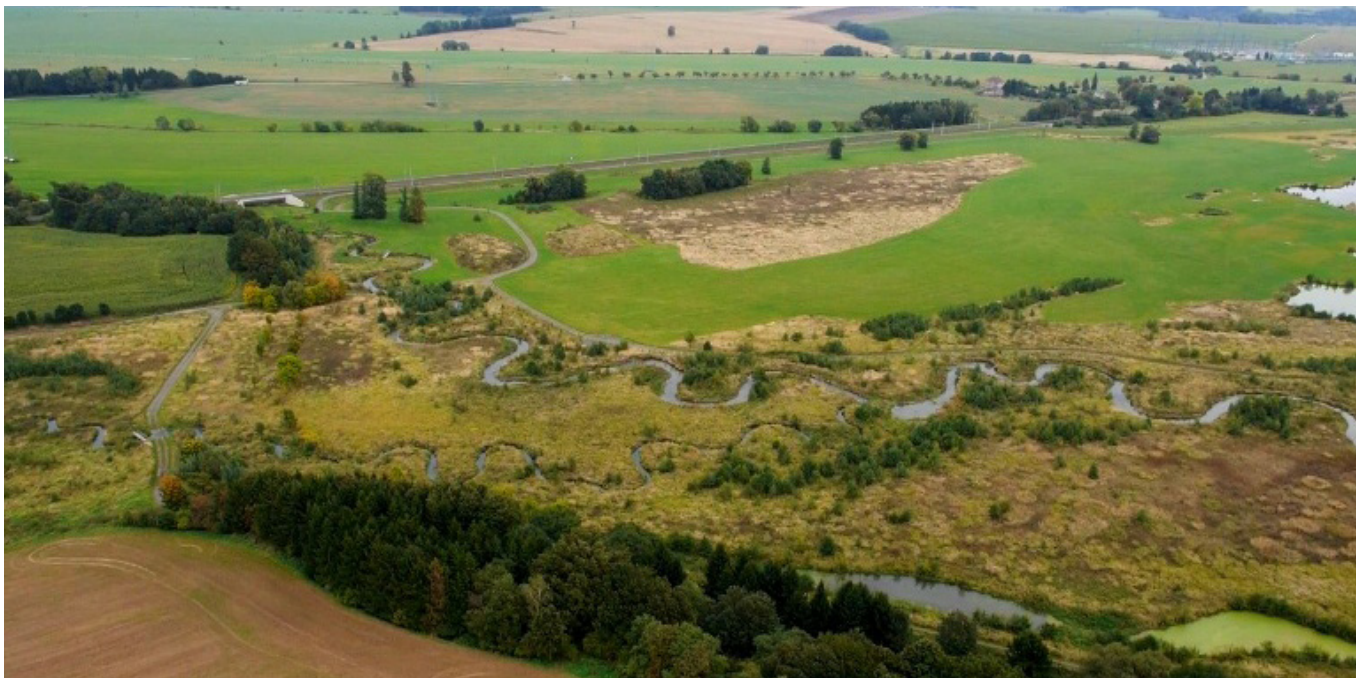
Inspirace - obnova přirozeného toku koryta potoka s meandry - u obce Žichlínek
